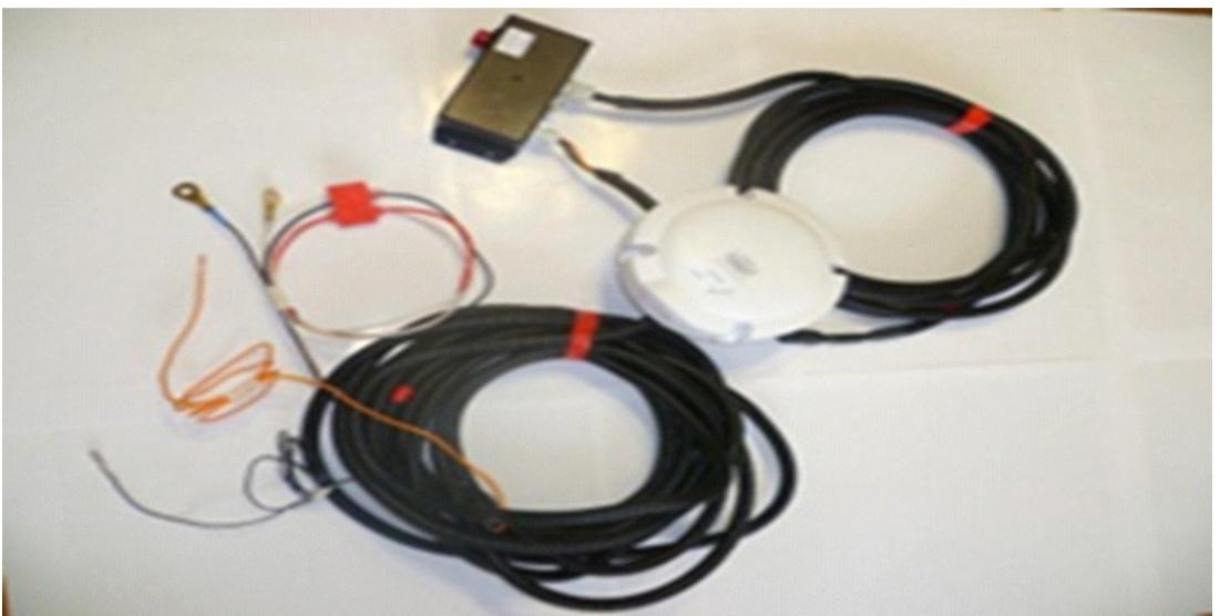
Рис. 1 AT «DMR-iSat» со спутниковым каналом передачи данных Inmarsat IsatM2M
